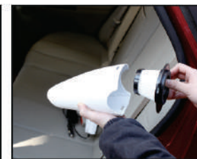
5. Retirar o filtro na recolha de condutas e limpar o lixo
